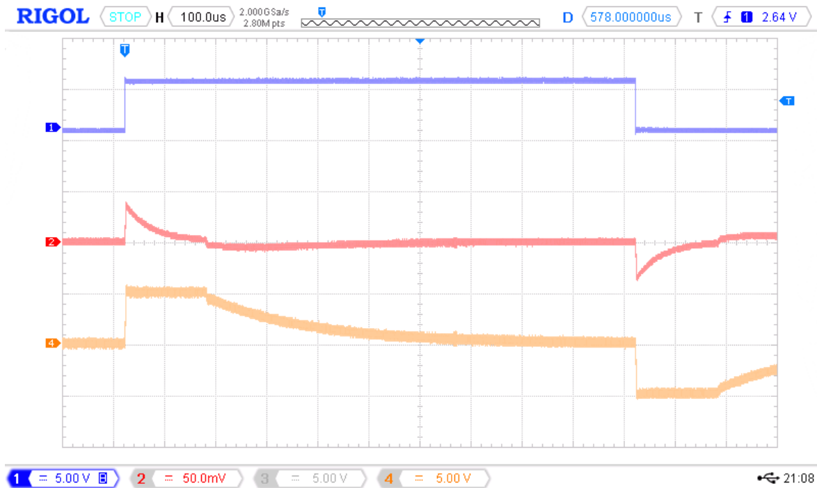
Abbildung 6.7: Ausgangssignal mit SMA-Anschluss (rot) und Tastkopf (orange)
