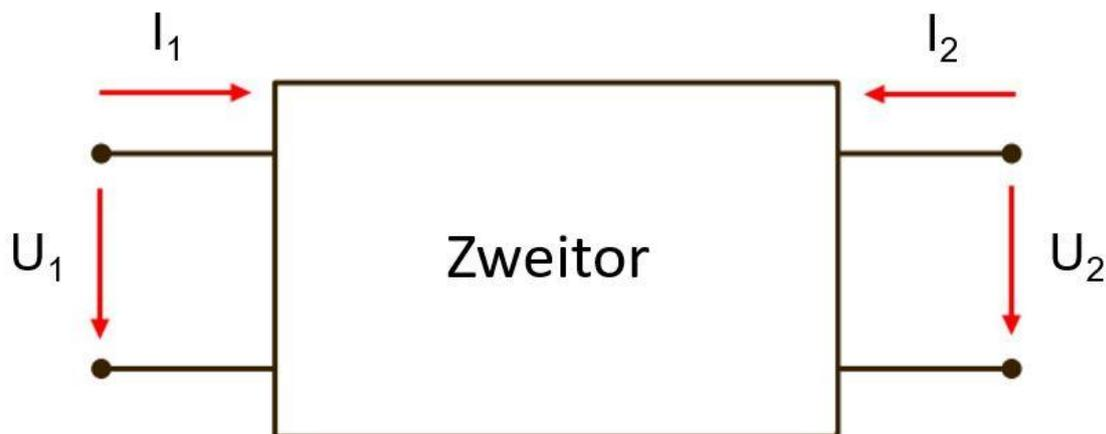
Abbildung 17 Strom- und Spannungsrichtung Zweitor-System (In Anlehnung an [11])
