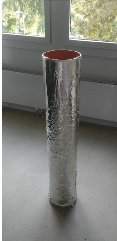
Abbildung 43 Zylinderförmiges Störobjekt, Symmetrie in X-Y-Ebene
