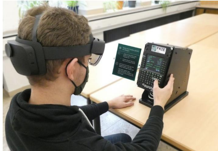
Abb. 2: Versuchsaufbau mit exemplarischer Darstellung der AR-Elemente.
