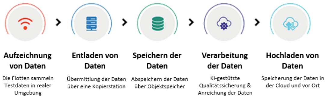
Abbildung 21: Der Weg der Daten von der Straße ins Rechenzentrum und in die Cloud (eigene Darstellung) (Analog zu: Nguyen, Autonomes Fahren beginnt im Rechenzentrum, 2020)
