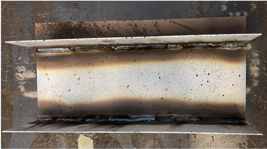
Abbildung C 8: Herstellung einer Flachlängssteife mit der Schweißfolge aus C6
