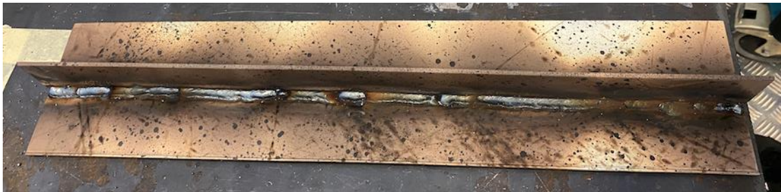
Abbildung C 4: Herstellung einer Flachlängssteife mit der Schweißfolge aus C1
