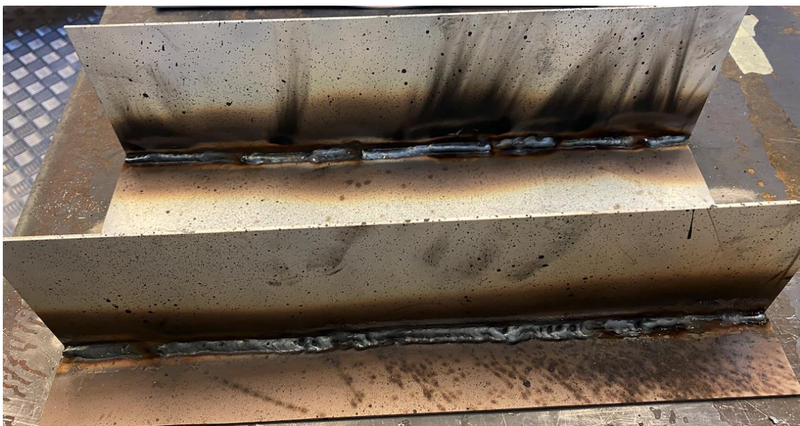
Abbildung C 9: Herstellung einer Flachlängssteife mit der Schweißfolge aus C6
