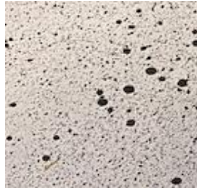
Abbildung 6: Grobes Speckle-Muster für Messungen im Fernbereich
