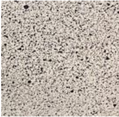
Abbildung 5: Feines Speckle-Muster für Messungen im Nahbereich
