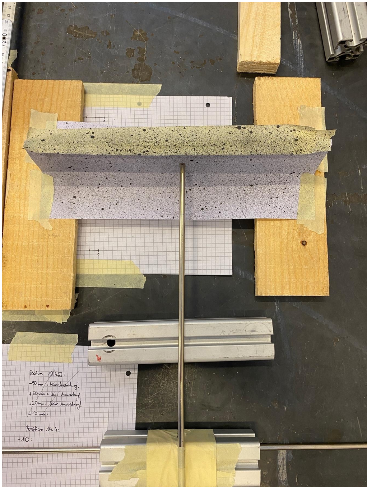
Abbildung B 1: Künstlich-vergrößerte Flachlängssteife (touchieren der Steife)
