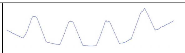
Abbildung 43: Beulform an Kante 2
