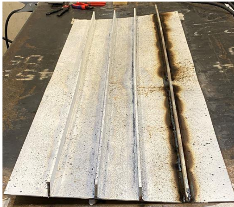
Abbildung 18: Fertige Herstellung Plattenbauteil des ersten Versuchs
