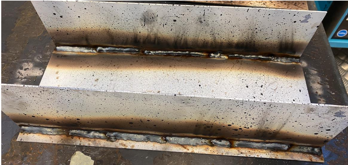
Abbildung C 10: Herstellung einer Flachlängssteife mit der Schweißfolge aus C6
